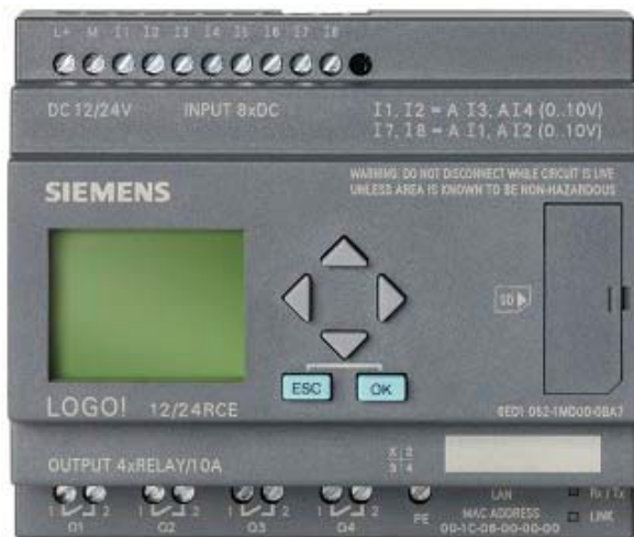
Figura 2: Privire de ansamblu modul LOGO! 12/24 RCE LOGO oferă soluții pentru automatizări de dimensiuni reduse cum ar fi:
